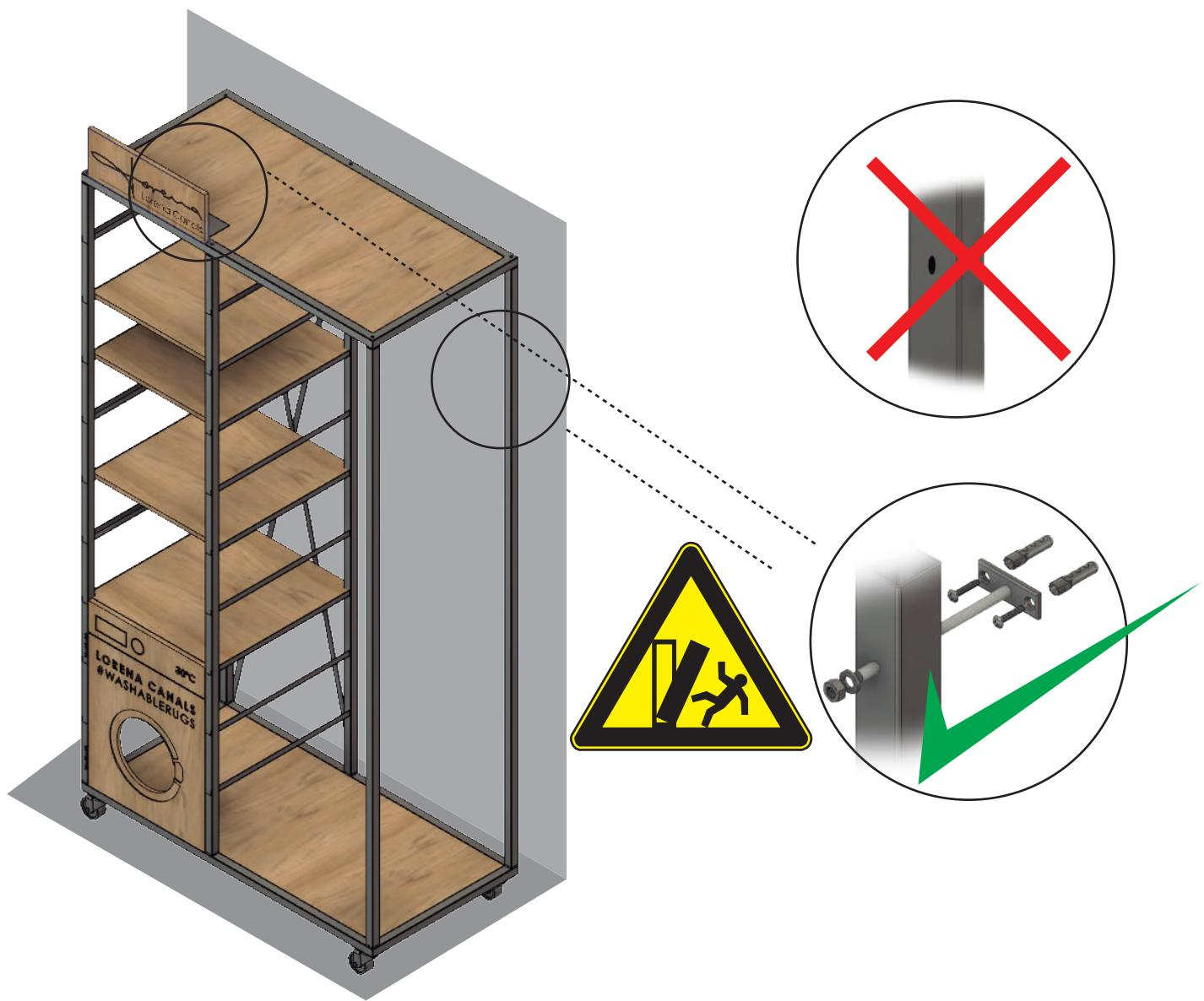
**Importante:** Por seguridad, una vez montado el expositor, debido a su altura, se debe fijar a la pared. Junto con el expositor, se entregan dos piezas de hierro especialmente diseñadas que sirven para anclar el expositor a la pared.
