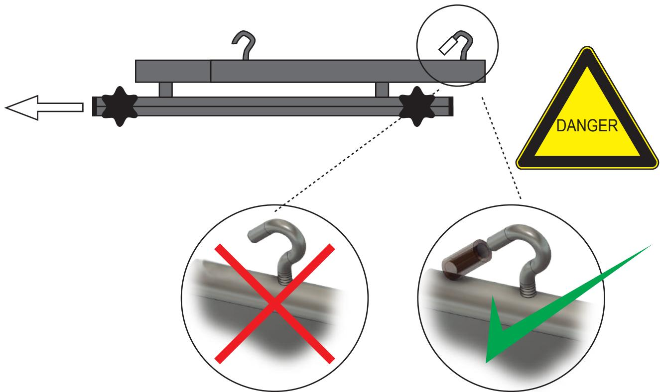
**Importante:** una vez colgada la percha, colocar los tubitos de plástico en los bordes de los ganchos – sirven de tope de seguridad.
